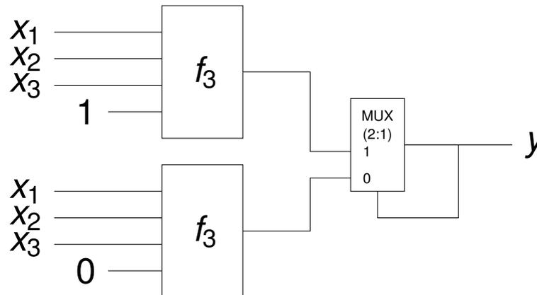
Entsprechend wird  $f_3$  parallel für beide möglichen Werte von  $y$  „vorberechnet“ und die langen Schaltzeiten reduziert, falls sich  $f_3$  durch die Rückkopplung ändern sollte. Der Nachteil liegt darin, dass diese Lösung mehr Fläche benötigt (d.h. Anzahl an Gattern und Leitungen).
