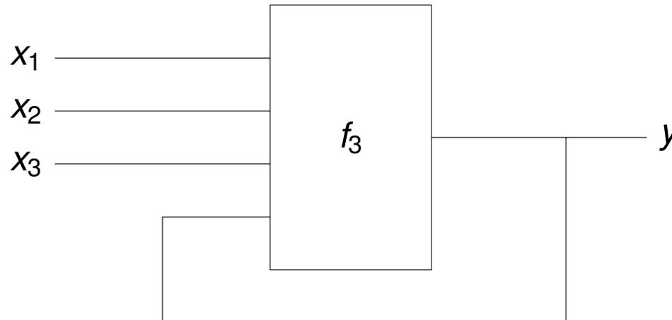
Nutzen Sie den Entwicklungssatz der Schaltalgebra, um den Einfluss der Rückkopplung auf die Laufzeit zu reduzieren und zeichnen Sie das resultierende Schaltnetz.
